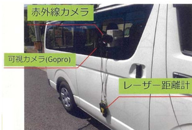
連続赤外線熱計測システムを搭載した車両の外観
