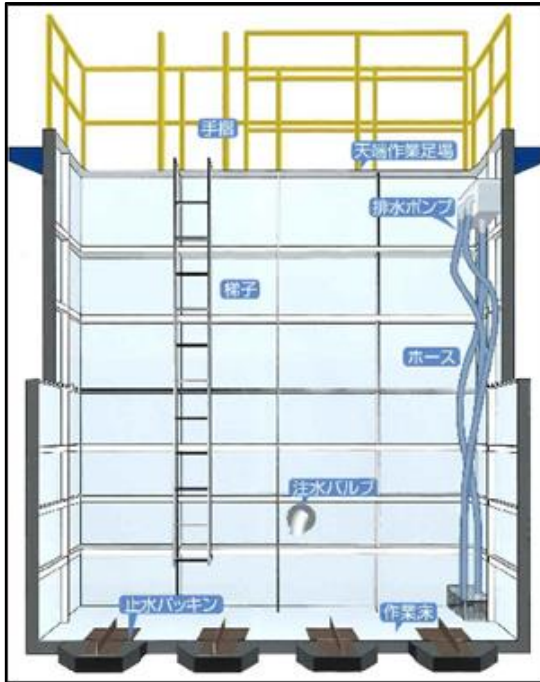
ドライ工法で使用するドライボックス
