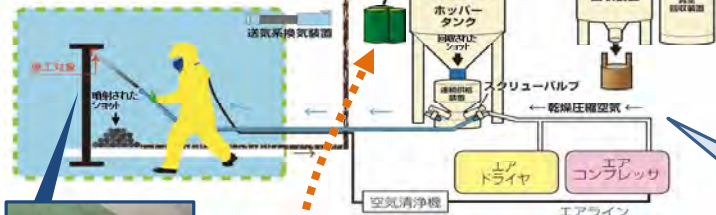
塗替え塗装工事と同時施工することで、 プラストと用の防護工を併用でき ショットの飛散防止が可能
