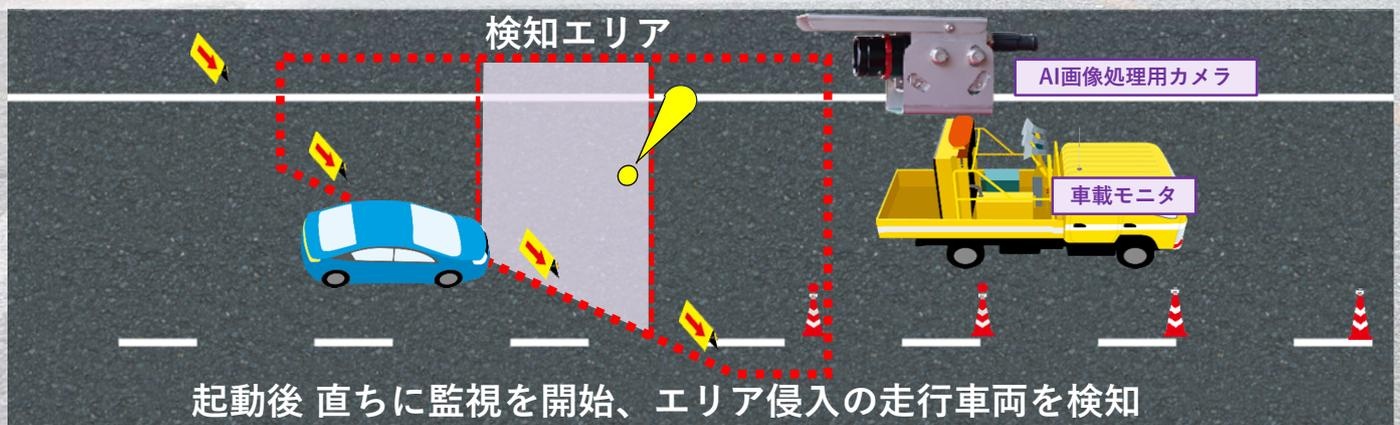
起動後 直ちに監視を開始、エリア侵入の走行車両を検知
