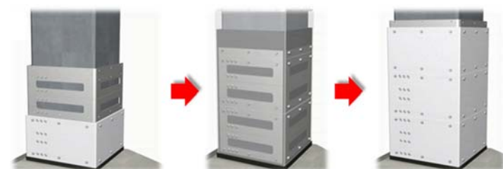
図1 CBパネル工法の施工概念図
