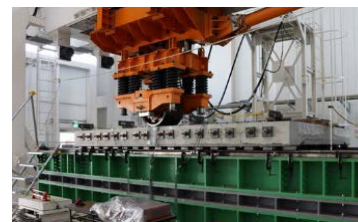
輪荷重走行試験状況
