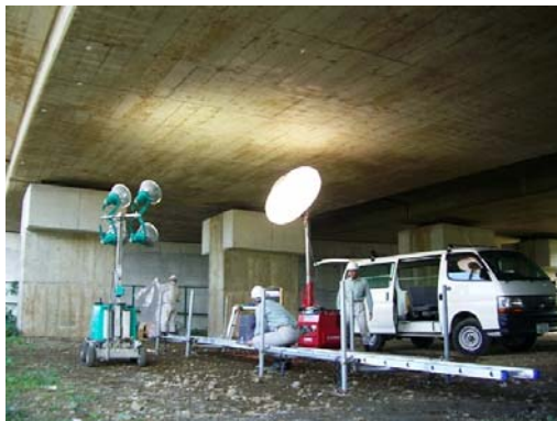
橋梁床版下面での撮影状況
