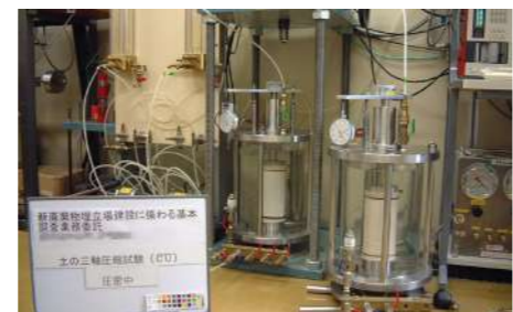
三軸圧縮試験圧密中
