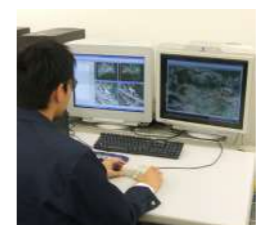
デジタル図化機によるデータ取得
