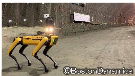
トンネル内点検・巡視 (鹿島建設)
