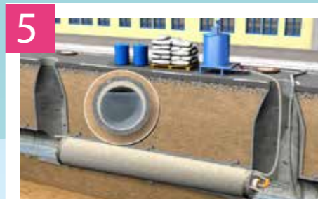
5 グラウト注入
