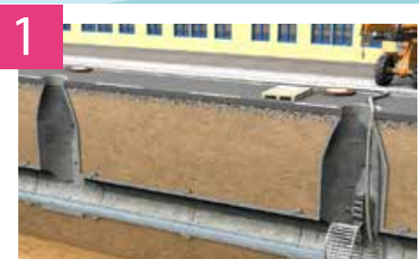
1 製管ケージ及び製管機設置
