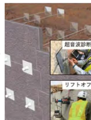
日本のインフラ老朽化が話題となる中、次世代により良い形で引き継ぐためにインフラ施設を維持管理する技術が重要となっています。当社では補強土壁の維持管理技術高度化のために超音波探傷法やリフトオフ試験などを駆使して土中にある補強材を診断、インフラの健全性を維持する技術開発を進めています。
