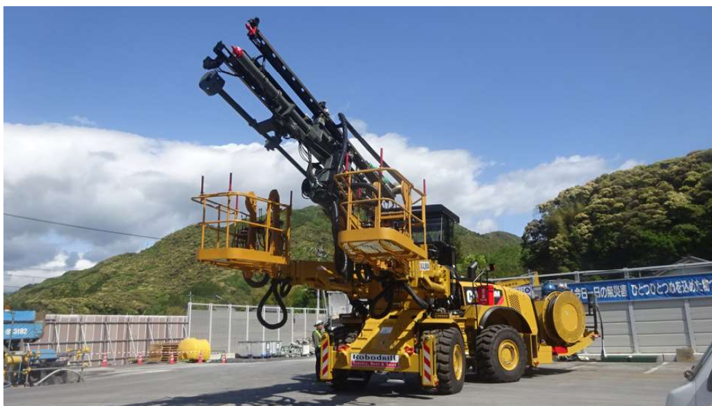
一連作業を完全に機械化したロックボルト打設専用機
