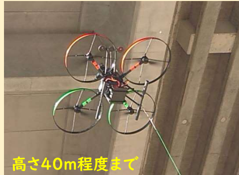
橋梁点検用ドローン3号機 (床版撮影用)
