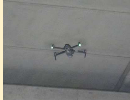
橋梁点検用ドローン4号機 (垂直面撮影用)
