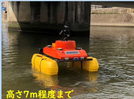
橋梁点検用ドローン5号機 (河川橋床版撮影用) 点検支援技術性能カタログ申請中
